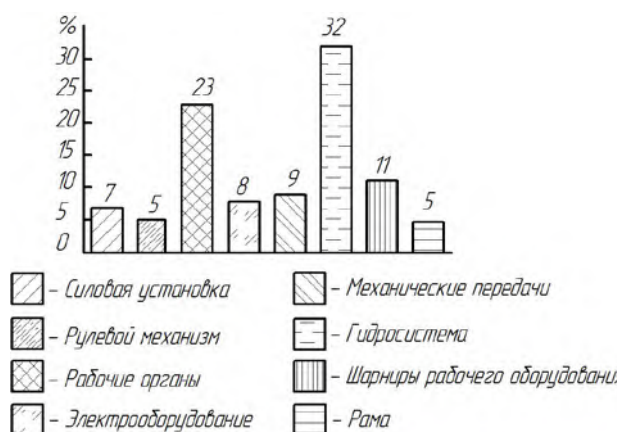
Рис. 2. Структура отказов на примере самосвала КамАЗ-5511
