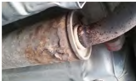
Рис. 2. Коррозия выхлопной системы
