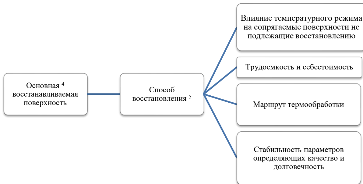
Рис. 2. Система «конструкция-способ восстановления» [2]
