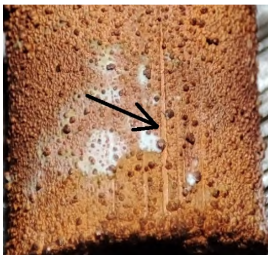
Рис. 10. Цилиндрический образец без изоляции кромок (5 А/Дм 2 , электролит № 1)
