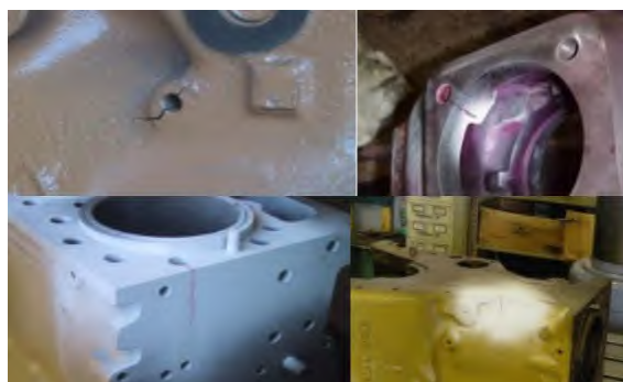
Рис. 5. Трещины блока цилиндров
