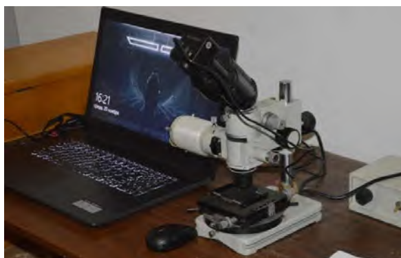
Рис. 3. Микроскоп ММУ-3, модернизированный видеоокуляр, с подключением к персональному компьютеру
