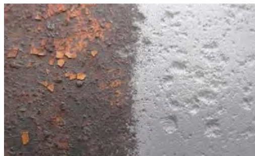
Рис. 3. Поверхность после применения преобразователя ржавчины
