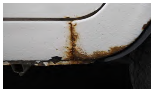
Рис. 4. Трещина на корпусе транспортного средства
