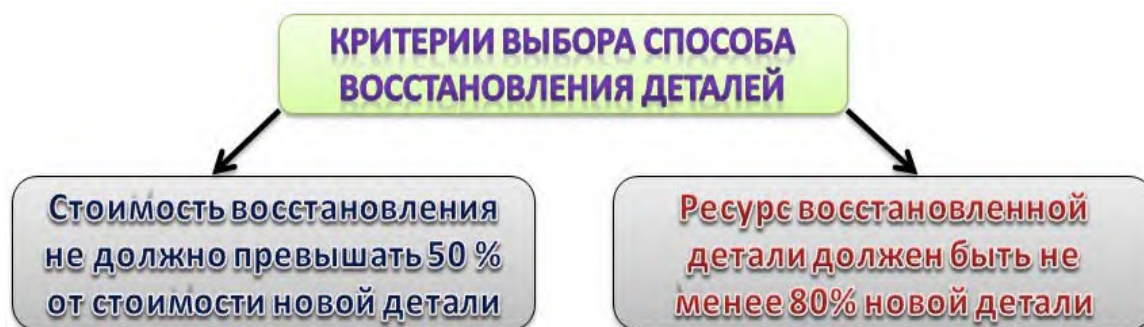
Рис. 1. Критерии выбора способа восстановления деталей автомобилей
